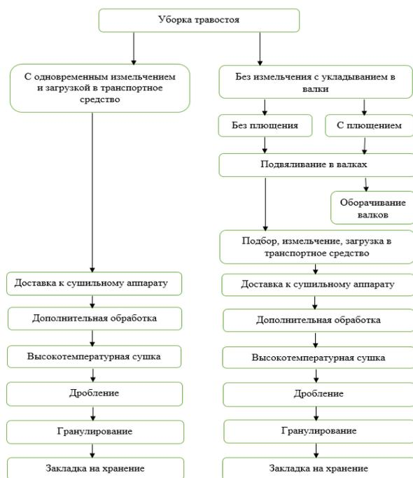
**Рис. Обобщенная схема технологических циклов производства травяной муки**
